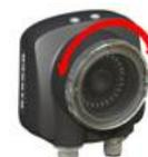
3. Une fois la mise au point terminée, bloquez la fenêtre de mise au point.
