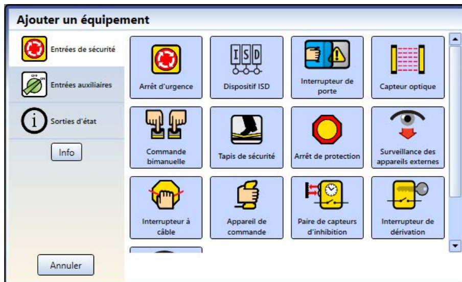
Illustration 56. SC10-2 : Ajout d'entrées à partir de la vue Équipement (la sortie d'état physique ne peut être ajoutée qu'à partir de cette vue)
