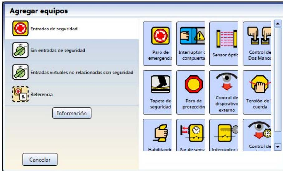
Imagen 50: SC10-2: agregue entradas desde la Vista del equipo (la salida de estado físico solo se puede agregar en esta vista)
