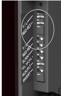
Figura 21. Configurazione dei DIP Switch per la programmazione delle opzioni di muting
