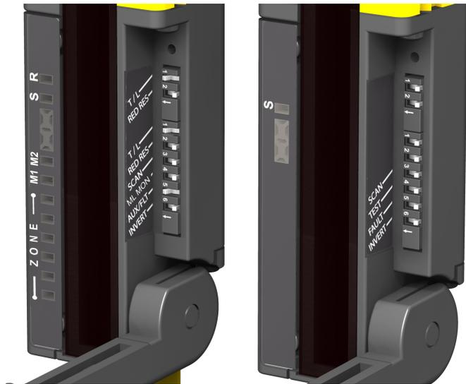
Illustration 29. Accès aux interrupteurs de configuration
