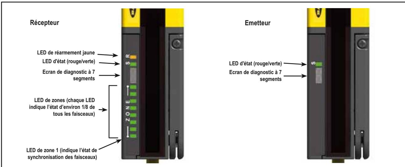
Figure 1-3. LED d'état de l'émetteur et du récepteur EZ-SCREEN LP
