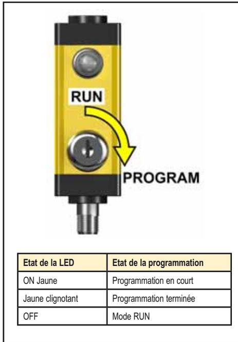
Figure 7-11. Etats de programmation et des positions de l'interrupteur EZA-RBK-1
