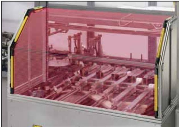
Figure 7-1. Plusieurs barrières immatérielles en cascade pour protéger une machine à l'ouverture irrégulière
