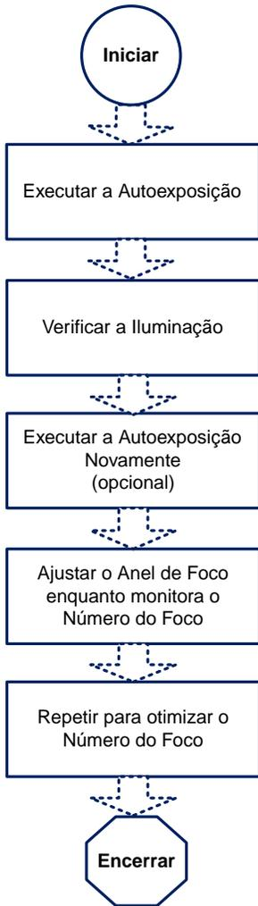
El sensor Serie iVu necesita capturar una buena imagen de cada pieza para garantizar que aprueba en forma correcta las piezas buenas y rechaza las piezas malas. El organigrama que se muestra a la izquierda provee una vista general de los pasos a seguir para conseguir una buena imagen.
