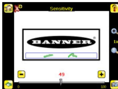
2. Utilizzare il cursore nella parte inferiore della schermata per regolare la sensibilità osservando mentre il sensore rileva più o meno edge.
