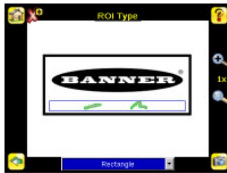
2. Modificare i parametri del sensore facendo clic all'interno della ROI, quindi sul pulsante con il nome del sensore.
