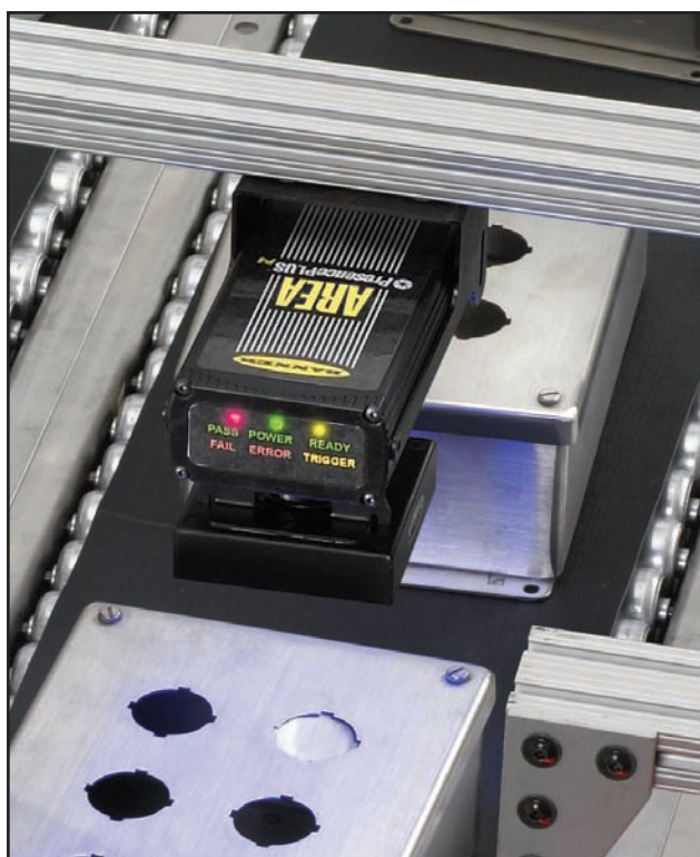
Abbildung 2-1. Typische Anwendung von PresencePLUS P4 AREA/AREA 1.3
