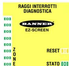
**Se il sistema è configurato in modalità Latch:** L'indicatore di reset giallo deve lampeggiare e l'indicatore di stato deve essere acceso con luce rossa **[O]**.
