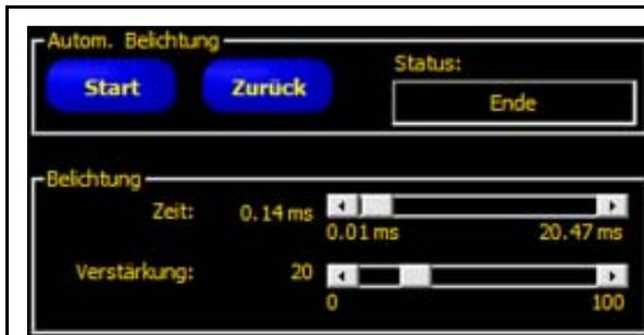
Zur manuellen Einstellung von Belichtungszeit und Verstärkung: Verschieben Sie die Schieberegler im Belichtungsfenster nach links oder rechts. Verschieben Sie die Regler nach links, um das Bild abzudunkeln, und nach rechts, um das Bild aufzuhellen. Um zu den vorherigen Belichtungswerten zurückzukehren, klicken Sie die Schaltfläche **Rückgängig** an. Siehe die nachstehende Abbildung zum Fenster für die automatische Belichtung.
